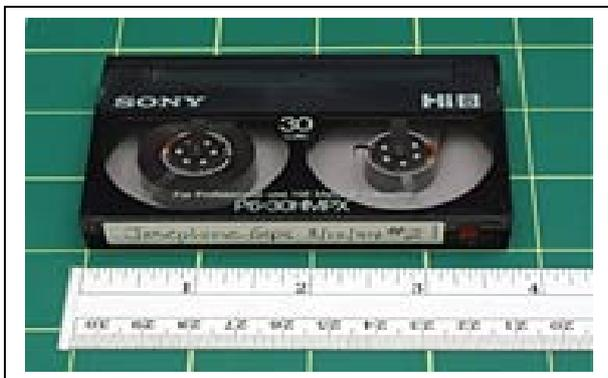
Bild 16: Hi-8-Kassette des ME-Typs<sup>18</sup>
