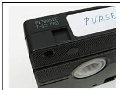
Bild 24: VHS-Kassette im gesicherten Modus<sup>26</sup>
